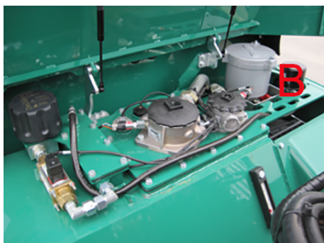
Fig. 33 Byte av off-line filter, hydraulolja
