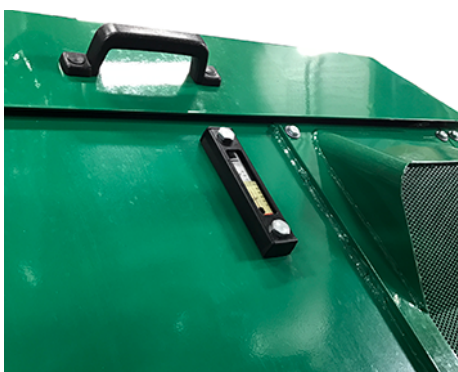
Fig. 94 Nivåglas på hydraultank
