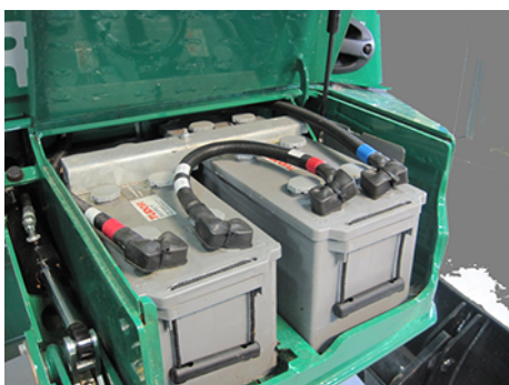
Fig. 142 Batterier i höger grenavvisare
