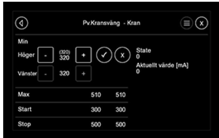
Fig. 66 , GreControl, inställning av kransväng
