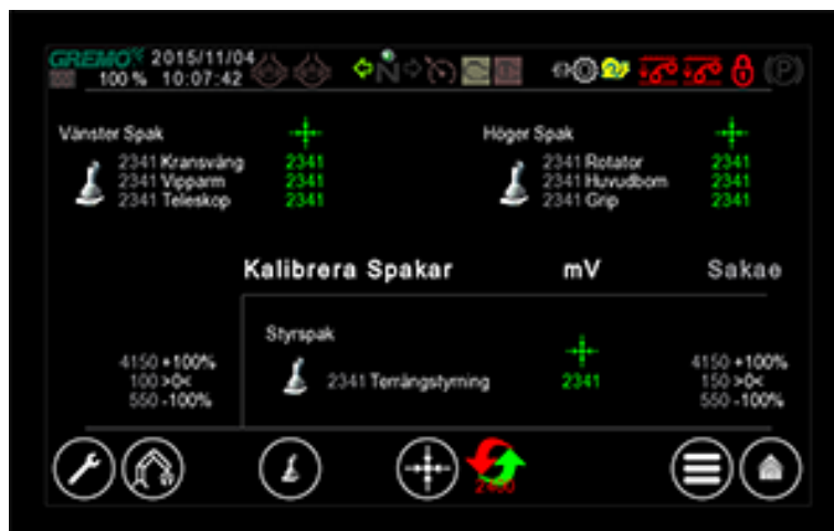
Fig. 62 GreControl, kalibrera spakar
