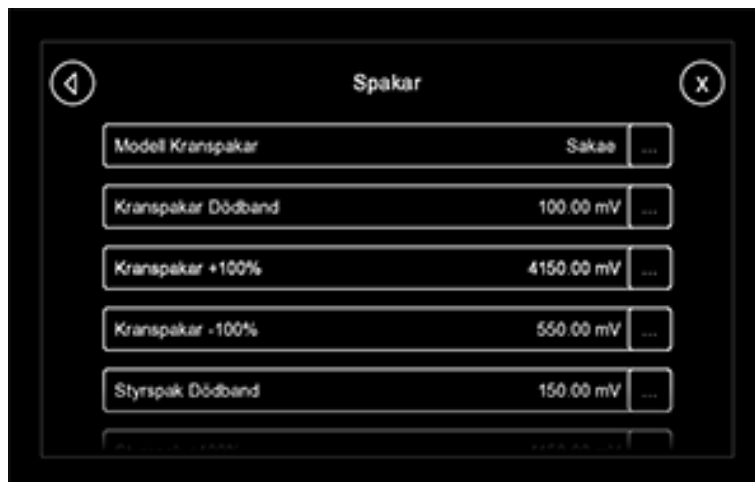
Fig. 63 GreControl, inställning spakar
