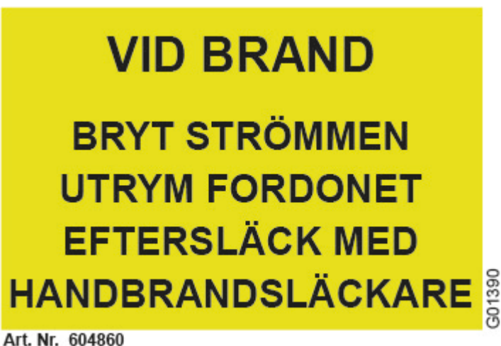
Fig. 25 Varningsskylt vid brand
