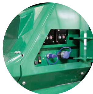
Anslutningar med snabbkopplingar och brytare för diesel och hydraulolja (tillval vakum)
