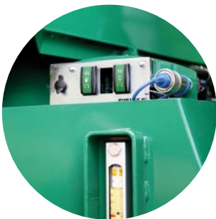
Elpump med autostopp och snabb koppling för bränsle och vakuum pump (tillval)
