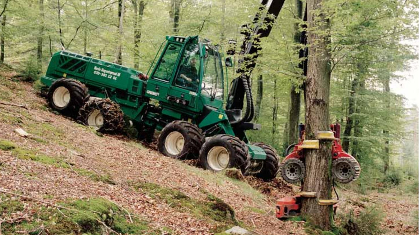
Благодаря низкому центру тяжести и небольшому весу машины, а также 8-ми колесной формуле харвестер Greta очень эффективен в эксплуатации на заболоченных грунтах и крутых уклонах. Отличная устойчивость позволяет работать даже при полном вылете стрелы. Среда оператора эргономична, полная звукоизоляция кабины, климат-контроль и великолепная обзорность создают идеальное рабочее место.
