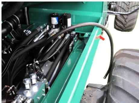
Fig. 30 Purge du réservoir
