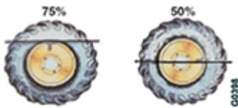
Fig. 2 Niveau, remplissage des pneus avec du liquide
