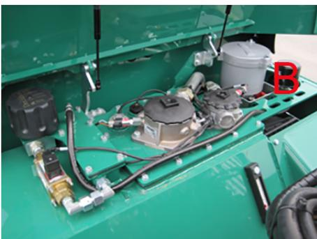
Fig. 33 Remplacement de filtre hors circuit, huile hydraulique
