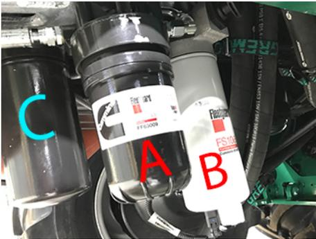
Fig. 16 Retrait de filtre à carburant
