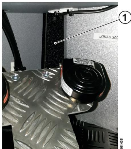
Fig. 26 Filtre de recirculation
