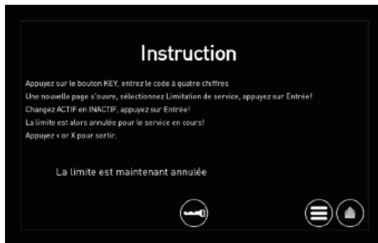
Fig. 80 GreControl, activation de limite
