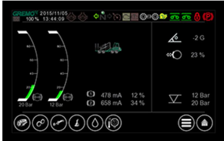
Fig. 82 GreControl, fenêtre de surveillance des freins
