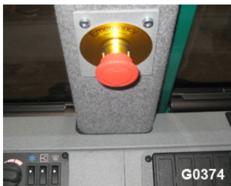
Fig. 12 Arrêt d'urgence depuis la cabine de conduite
