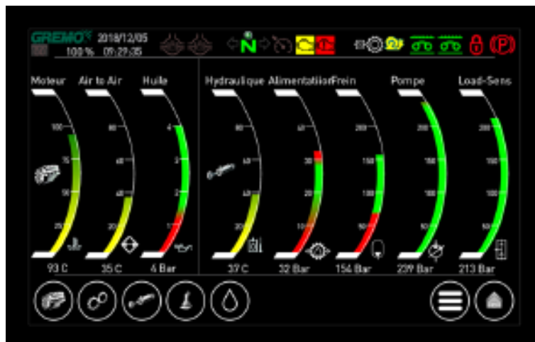
Fig. 66 GreControl, fenêtre de température et de pression
