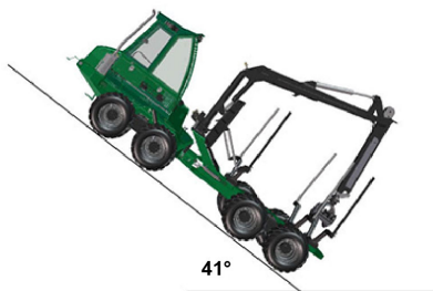
Fig. 112 Conduite en montée
