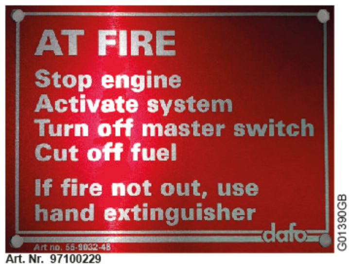
Fig. 26 Étiquette d'avertissement en cas d'incendie
