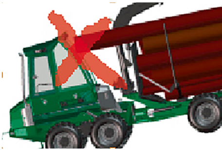
Fig. 115 Chargement dépassant le haut de la barrière
