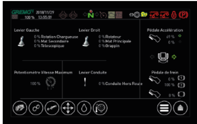
Fig. 62 GreControl, fenêtre de leviers
