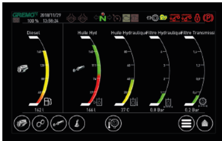
Fig. 65 GreControl, fenêtre de niveau de réservoir
