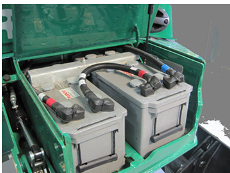
Fig. 143 Batteries dans déflecteur de branches droit
