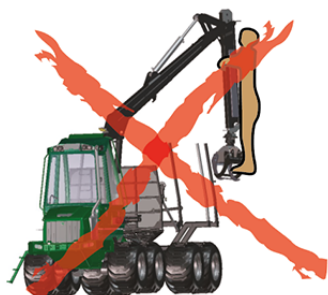
Fig. 22 Levage de personnes avec la grue
