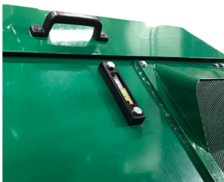
Fig. 149 Vérification du niveau dans le réservoir hydraulique
