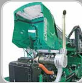
Diseño simple y fluido que eleva el filtro de partículas cuando se repara el motor.
