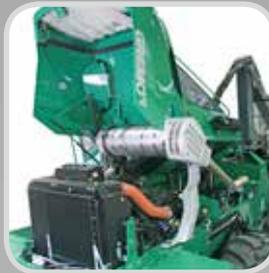
El capó abre hacia atrás a través de dos resortes a gas lo que alza el capó bastante alto para gran amplitud. Esto, combinado con el nuevo chasis abierto, presta gran utilidad para servicios. Los filtros del motor (combustible y aceite) están montados sobre un brazo que puede desplegarse a un costado de la estructura. Lo cual es una gran ventaja al momento de cambiar los filtros.
