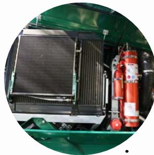
Die Kühler sind seitlich montiert statt hinten und vorn. Das sorgt für einen niedrigeren Lärmpegel in der Fahrerkabine und verbessert die Sicht nach hinten.
