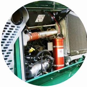
Der Motor ist ein Stufe-V-Modell ohne AGR-Ventil. Die Nachbehandlung der Abgase erfolgt stattdessen in einem „Single Module“. Das spart Platz und führt dazu, dass die Einbaumaße wesentlich geringer ausfallen als bei früheren Modellen.
