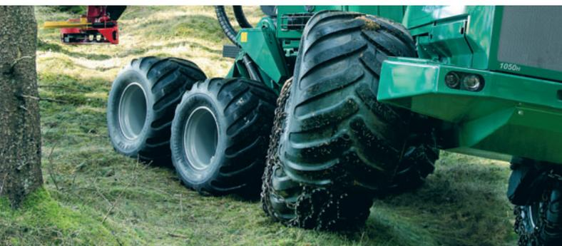
Acht Räder sorgen für hervorragende Mobilität im Gelände und souveräne Tragfähigkeit. Der Achslift des Hinterachsaggregats erlaubt u.a. schnelles Einfahren in Rückegassen und Auslichtungsbereiche.
