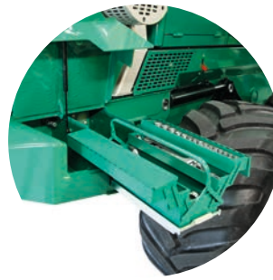
Beheizbares Außenstaufach für Werkzeugkasten am linken Astabweiser.
