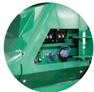
Anschlüsse mit Schnellverbindungen und Schalter für Diesel und Hydrauliköl
