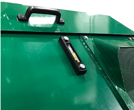
Bild 94 Sichtglas des Hydrauliktanks
