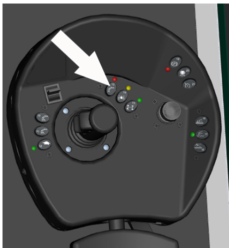
Bild 113 Steuerungen, Kranbetrieb, Sitz nach vorn ausgerichtet
