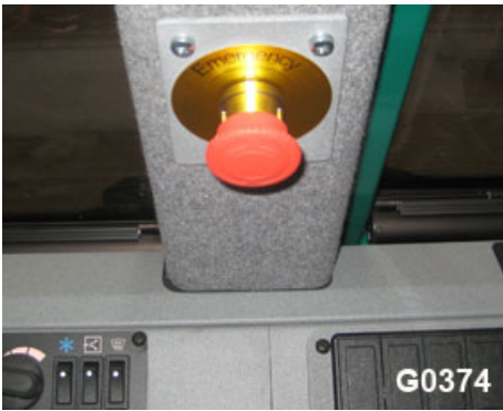
Bild 11 Notausschalter in der Kabine
