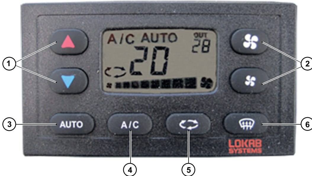
Bild 50 Bedienfeld für die Klimaanlage
