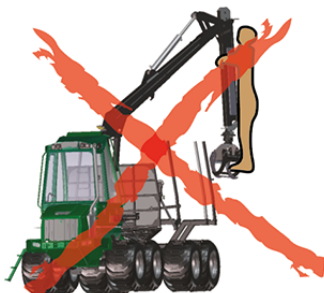
Bild 21 Anheben von Personen mit dem Kran
