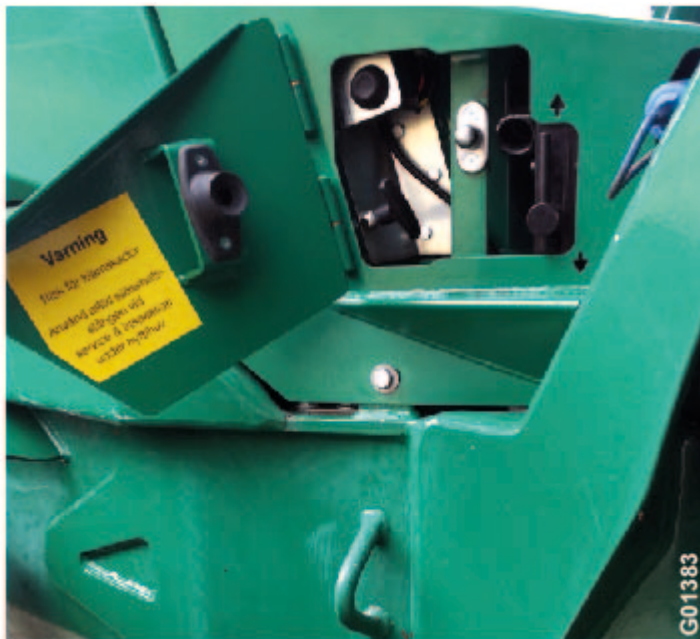
Bild 32 Schutzabdeckung zur Kontrolle der Kabinenneigung
