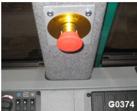
Bild 96 Notausschalter in der Kabine
